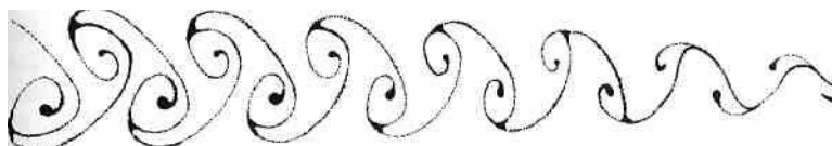
Flg. 9. El flujo de un líquido sobre un delgado filamento produce los complicados vórtices aquí representados que recuerdan algunos rasgos superficiales del planeta Júpiter. (Reproducido con el permiso del Dr. David Tritton.)
